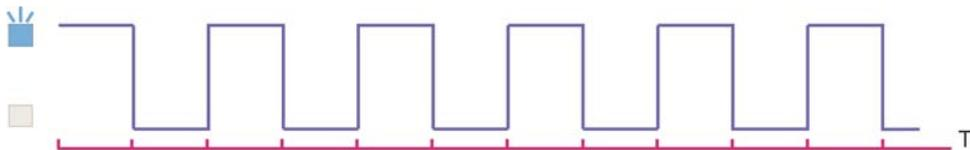
**2) lampeggio rapido con attesa di un secondo:** lampeggio quando il riconoscimento del Can Bus è andato a buon fine con quadro acceso.
