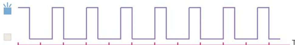
**3) lampeggio rapido con attesa di cinque secondi:** lampeggio quando il riconoscimento del Can Bus è andato a buon fine con quadro spento fino allo stato di sleep.
